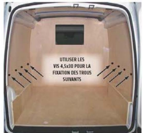
5 - Fixer les passages des roues au plancher avec les **Vis 4,5 X30** et mettre les capuchons plastique.
